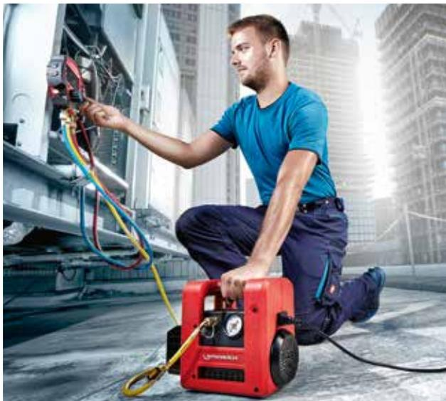
Il set ROAIRVAC contiene: pompa per il vuoto con raccordi da 1/4", 5/16" e 3/8" SAE, valigetta di plastica con olio minerale (300 ml)
