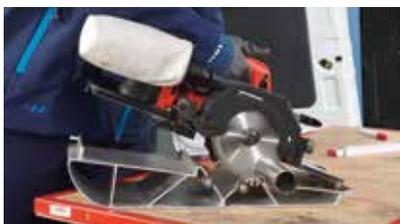
Possibilità di utilizzare PIPECUT mini anche come sega circolare, ad immersione o trasversale
