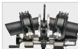
Assortimento completo della macchina (No. 55844): macchina base (No. 55787) con supporto da banco, fresa manuale, specchio teflonato con regolazione elettronica (No. 55826), serie morse base T/T (No. 55807) (Ø 110 mm) e morsa base T/R sinistra (No. 55808) (Ø 110 mm), serie riduzioni T/T e T/R da Ø 40 - 90 mm, chiavi di servizio (No. 55524), supporto per tavolo e cassa di trasporto (No. 55832)
