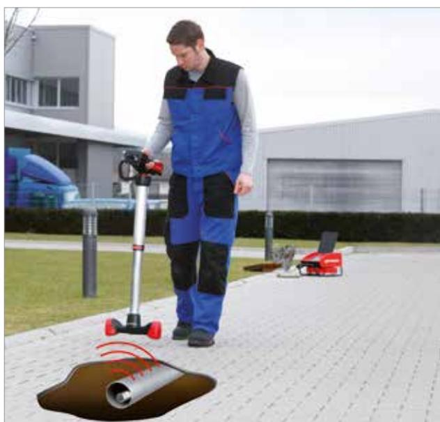
Ideale per la localizzazione di tubi e sonde, con indicazione precisa della profondità
