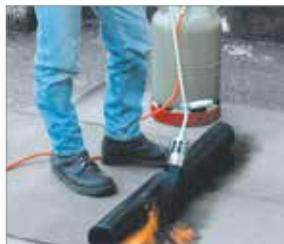
Tubo da 600 mm con supporto cannello e tubo per gas propano da 5 mm
