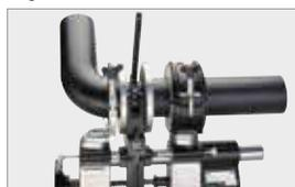
Morsa base girevole di 15° per parte, per la formazione di curve e segmenti
