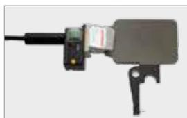
Fissaggio del tubo tramite ganasce larghe o strette
