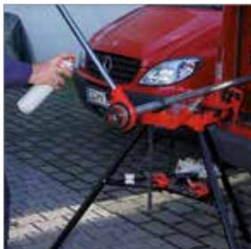
Il set (No. 70600) comprende: SUPERCUT e cricco da 1.1/4" (No. 70840X), testine intercambiabili BSPT R 1/2" (No. 070823X) - 3/4" (No. 070824X) - 1" (No. 070825X), tagliatubi per ferro SUPER 1.1/4" (No. 70040), pinza rossa tipo SP 10" (No. 70528), in alternativa un giratubo 1" (No. 070122X) un rotolino di teflon (No. 855360), in cassetta di plastica
