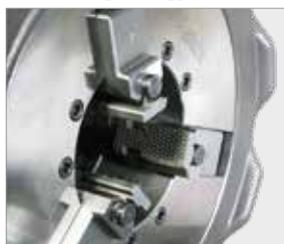
Testa automatica con rapida regolazione della dimensione del filetto, dispositivo automatico per la lunghezza del filetto e regolazione precisa della profondità del filetto senza una nuova regolazione.
