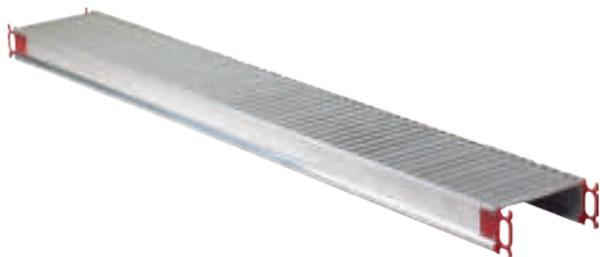
Passerelle in alluminio con lunghezze da 4 a 8 m. Possono rimanere sospese tra due supporti o trabattelli. Leggere e maneggevoli possono essere unite e formare un impalcato unico o essere capovolte per diventare una passerella singola dotata di fermapiede integrato. Ogni passerella è dotata di ganci in acciaio alle estremità per essere montate su tubi Ø 50 mm (trabattello Tempo). Bastano pochi minuti per ottenere un camminamento solido, leggero ed inattaccabile dalla ruggine.
