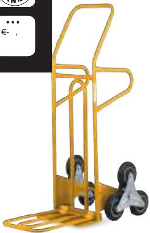
Carrello saliscale. Carrello in acciaio verniciato con polveri epossidiche. Ideale per utilizzo su gradinate o scale che supera agevolmente tramite 6 ruote di alta qualità, rotanti in gomma piena ø 150 mm. La struttura è costituita da robusti tubolari saldati ø mm 25. Dotato di pedana ribaltabile maggiorata. Rinforzi telaio interno in tubolare.
