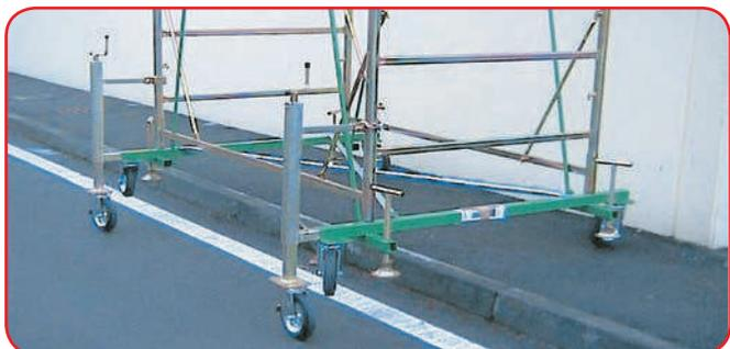
Grazie al sistema telescopico, serve a livellare il trabattello consentendone lo spostamento in presenza di marciapiedi o leggero pendio. Rapido da montare e molto stabile, è costruito in acciaio, pesa Kg 12,5 ed è dotato di ruota Ø 200 mm con freno. Regolazione 50 cm. (In fase di lavoro si ha comunque l'obbligo di montare le 4 staffe stabilizzatrici).
