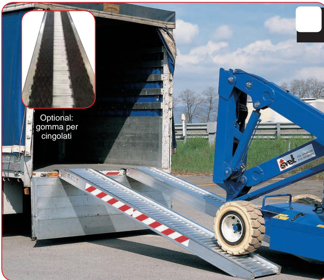
Costruite in estruso di alluminio nervato ad altissima resistenza meccanica. Permettono di sostenere carichi fino a 9.500 Kg. Ideali per il carico delle piattaforme aeree e di altri macchinari. Dotate di staffe di aggancio sugli automezzi. Non idonee per i cingolati.
