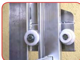
Cilindri di scorrimento in teflon
