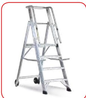
Scala doppia a gradini ad un tronco di salita provvista di ampia piattaforma, guarda-corpo e corrimano di salita. Ideale per utilizzo professionale. In alluminio estruso nervato é costruita saldando i gradini ai montanti, ottenendo un monolito ultrasensibile. Può essere aperta e chiusa in pochi secondi.
