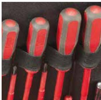
Fasce di elastico fissate con robuste cuciture a passo variabile, creano uno stabile alloggio per utensili di diversa grandezza e spessore.
