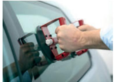
**LATERALE:** di solito molto piccolo e quindi necessita di una singola ventosa.
