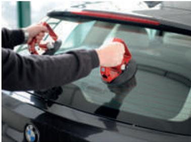
**LUNOTTO:** il lunotto viene montato da un operatore che necessita di 2 ventose singole.
